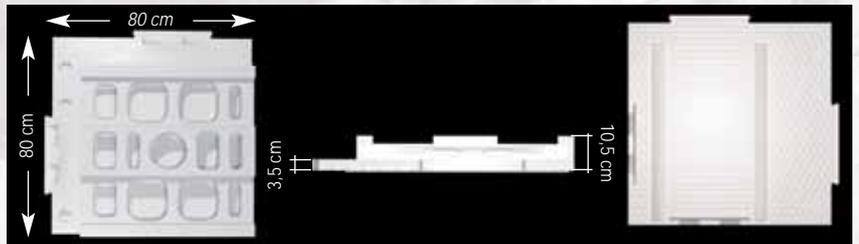
Canto estructural total = canto estructural del tablero + canto de a casetón + capa de compresión.
